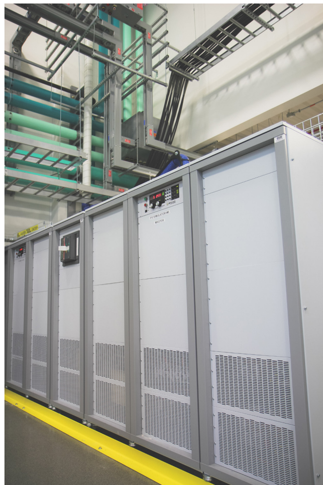
1.5 MW太阳能电池阵列模拟器在科罗拉多州戈尔登的国家可再生能源实验室 (NREL) 使用麦格纳电子设备公司的MT系列电源
